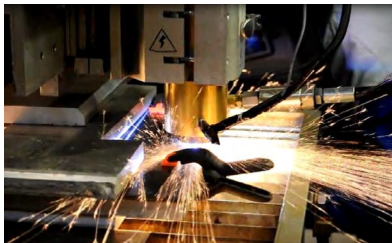
Torche de coupage automatique Akryvia en fonctionnement
